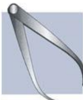
Przymiar (macka) by sprawdzać wymiary zewnętrzne powierzchni do izolowania
